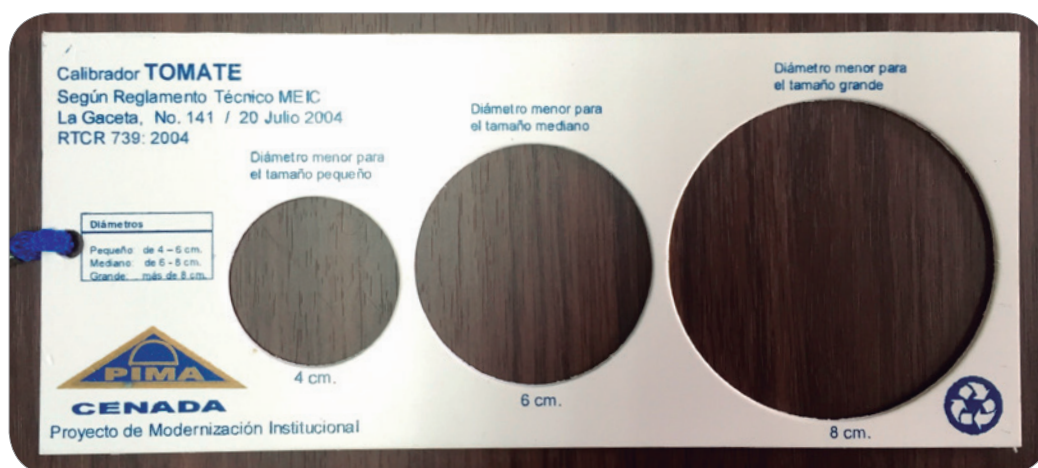
Figura 50. Calibrador de tomate para tamaño primera, segunda y tercera.
