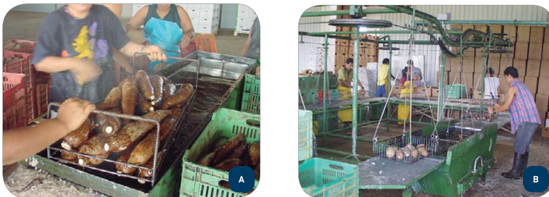
Figura 54. Parafinado de la yuca. A: con un equipo sencillo manual, B: con un equipo mecánico llamado “carrusel”.
