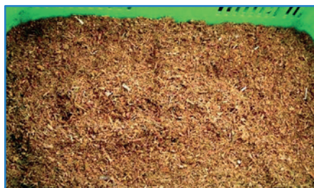
Figura 27. Fibra de coco gruesa, esta se utiliza en una proporción de 20 % del total del material a utilizar.
