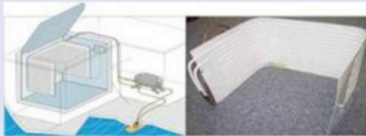
Fig 8. Evaporador de placas usado en refrigeradores
