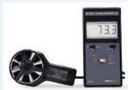
Fig 17. Anemómetro para medir el flujo de aire en los ductos
